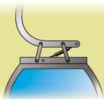
Movimenti oscillanti ammortizzati dai freni idraulici
