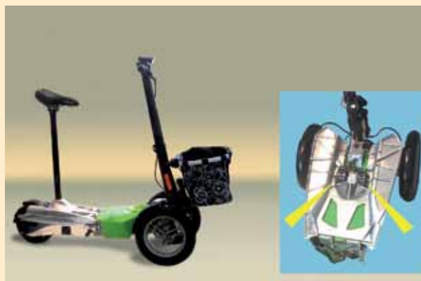
Il profilo di ammortizzamento di un TUBUS garantisce una guida confortevole di uno scooter elettrico
