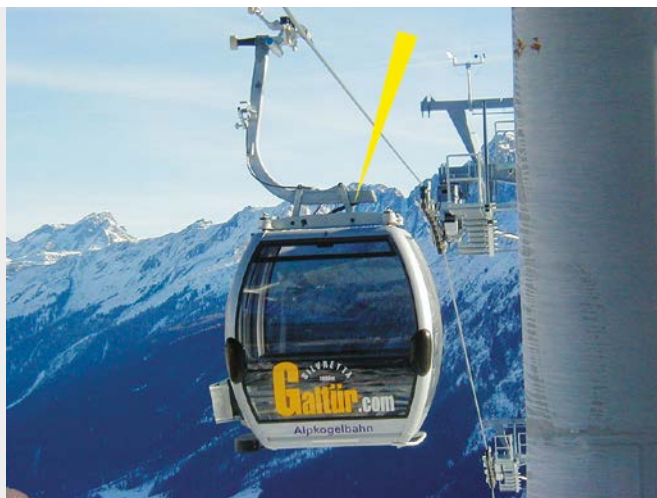
Des contrôleurs de vitesse hydrauliques améliorent le confort lors du fonctionnement des téléphériques
