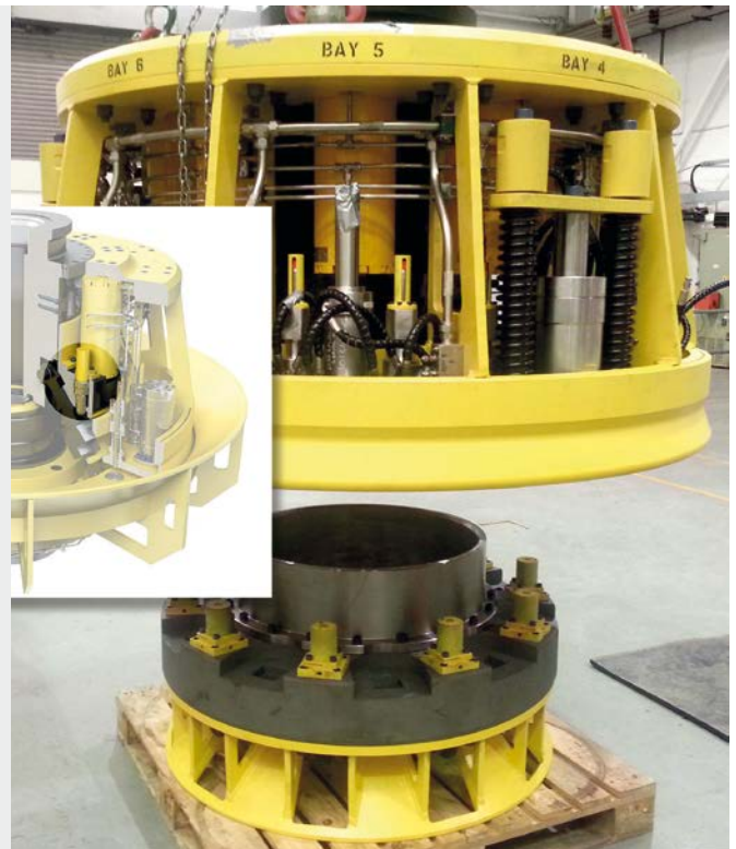
MAGNUM assure la déconnexion rapide d'urgence des pipelines des plateformes pétrolières Subsea Technologies Ltd, Aberdeen, AB12 3AY, Royaume-Uni
