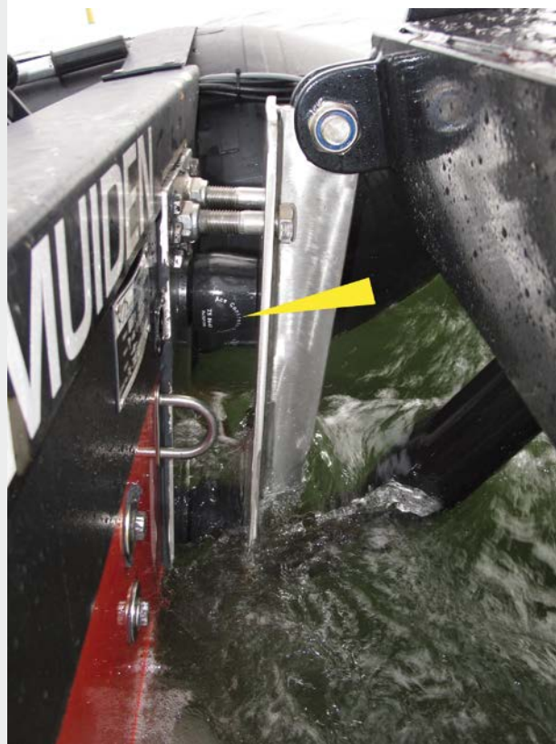
Les absorbeurs profilés TUBUS, robustes et résistants à l'eau de mer, en élastomère de type copolyester, permettent aux bateaux et aux équipages d'amarrer en toute sécurité Wals Diving and marine service, 1970AC Ijmuiden, Pays-Bas
