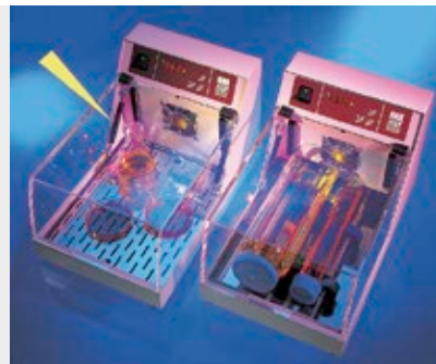
Mini-Inkubator, unter dessen Klappe sich Laborgut befindet, sehr kleine ACE Gasdruckfedern ermöglichen vorsichtige Öffnungs- und Schließbewegungen GFL Gesellschaft für Labortechnik mbH, 30938 Burgwedel, Deutschland
