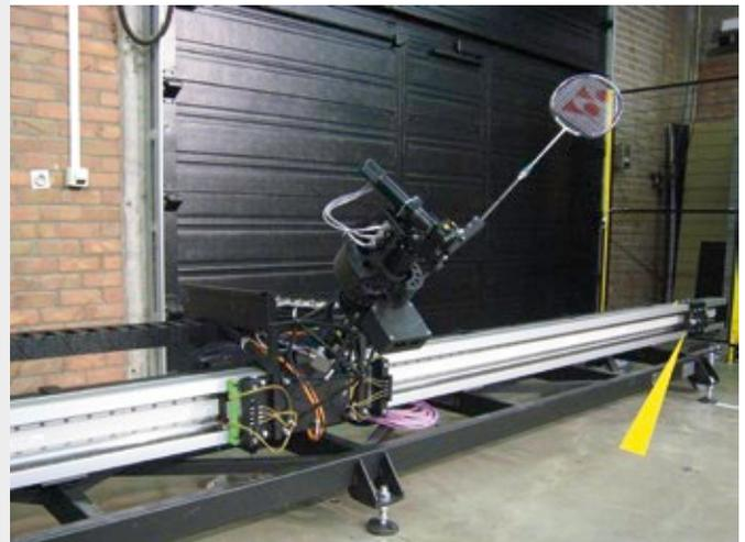
Unterschiedliche Dämpfer bremsen schnelle Bewegungen eines Badminton-Roboters
