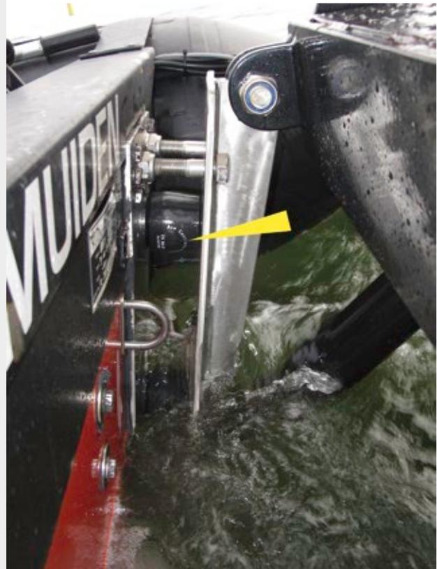
Seewasserbeständige, robuste TUBUS Strukturdämpfer aus Co-Polyester Elastomer lassen Boote und Besatzung sicher andocken
