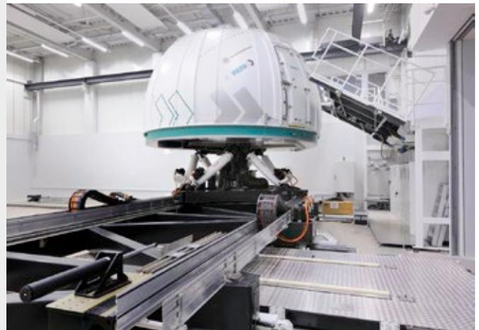
ACE Sicherheitsstoßdämpfer schützen Endlagen in zwei Achsen eines Fahrsimulators
