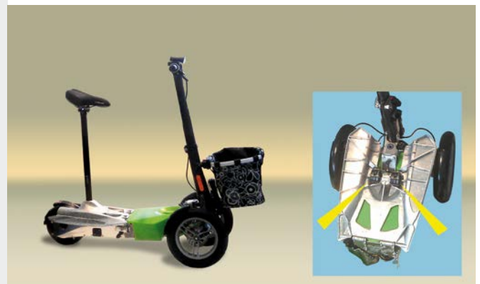
Structurdempers verbeteren het rijcomfort van een elektrische scooter
