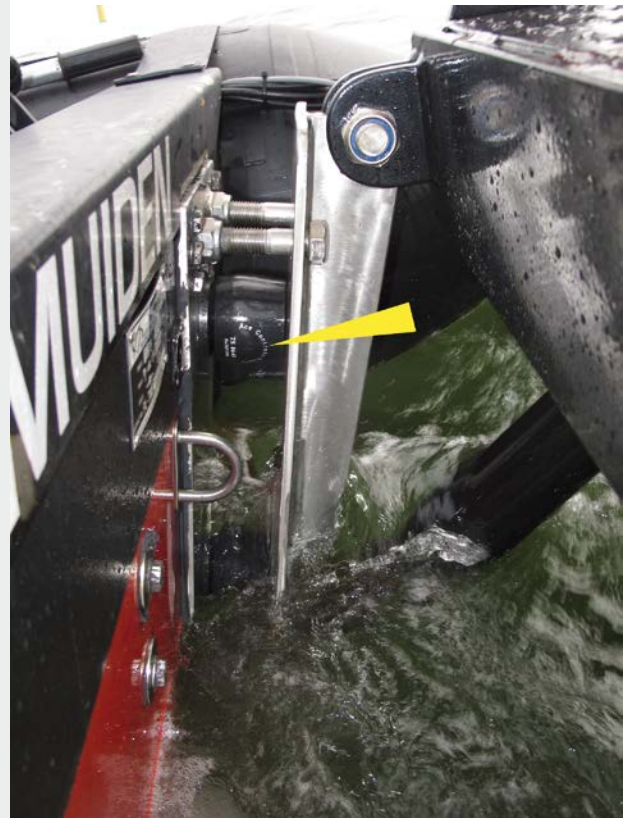
Zeewaterbestendige, robuuste TUBUS-structuurdempers van copolyester elastomeer zorgen ervoor dat boten en bemanning veilig kunnen aanmeren Wals Diving and marine service, 1970AC IJmuiden, Nederland
