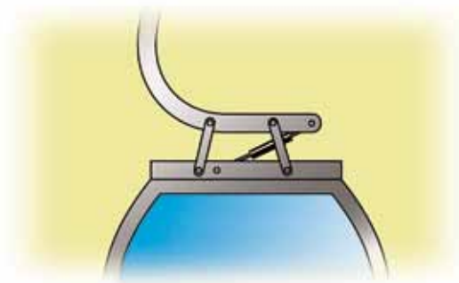
Kyvny pohyb tlumený hydraulickou brzdou
