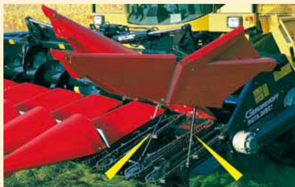
Zvýšená ochrana: Průmyslové plynové pružiny zajišťují bezpečnost u těžkých krytů
