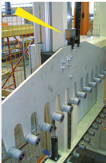
Accumulateur de matériau sécurisé
