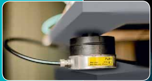
Drei dieser Luftfedererlemente des Typs PLM1 aus der ACEolator-Familie von ACE beruhigen nun den 3D-HDD-Projektor.
