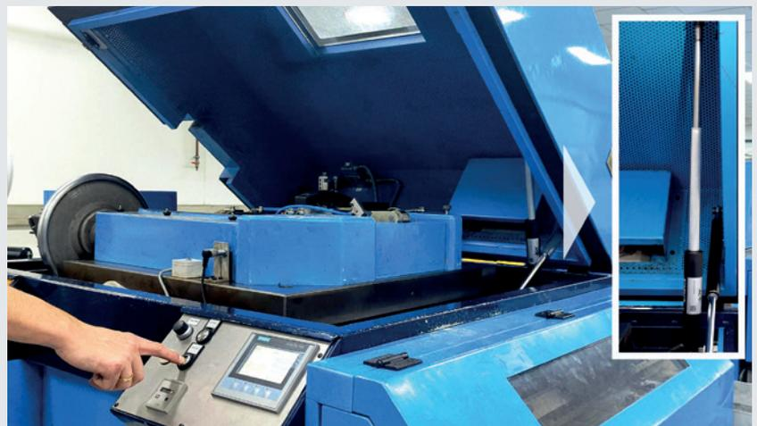
An den Hauben der KeyTec-Werkzeugmaschinen arbeiten Industrial POWERISE® Aktuatoren und Industriegasfedern von ACE Hand in Hand und erleichtern die Arbeit auf Knopfdruck.
