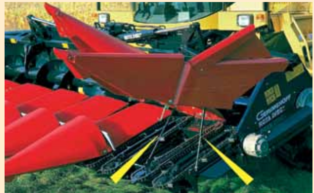
Artan koruma: Endüstriyel gazlı yaylar ağır kapakları emniyete alır
