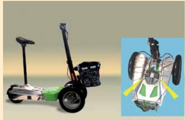
Profil damperler elektrikli scooterlarda da sürüş konforunu artırır
