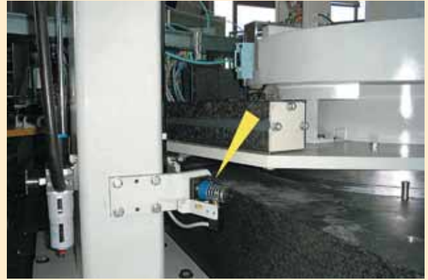
En uygun şekilde korunan döner tabla
