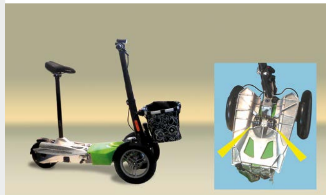
Strukturdämpfer erhöhen Fahrkomfort eines Elektro-Scooters
