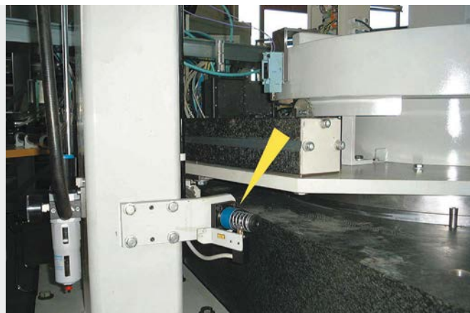
Optimal gesicherter Drehtisch
