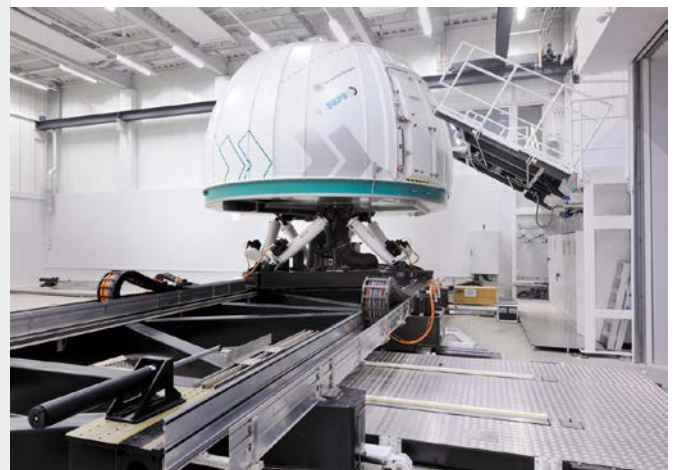
ACE Sicherheitsstoßdämpfer schützen Endlagen in zwei Achsen eines Fahrsimulators Bosch Rexroth B. V., 5281 RV Boxtel, Niederlande und Universität Stuttgart - FKFS, 70569 Stuttgart, Deutschland
