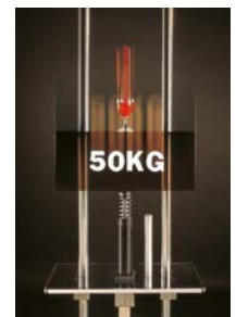
Freier Fall eines Weinglases aus 1,3 m Höhe. Abbremsung durch einen Stoßdämpfer, ohne einen Tropfen zu verschütten.
