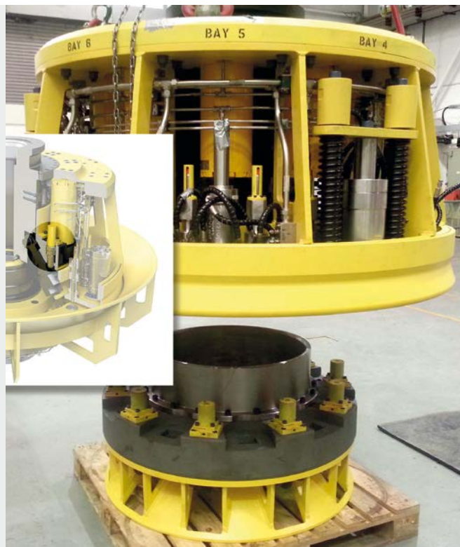
MAGNUMs maken het mogelijk de pipelines in geval van nood snel los te koppelen van de booreilanden Subsea Technologies Ltd, Aberdeen, AB12 3AY, Verenigd Koninkrijk
