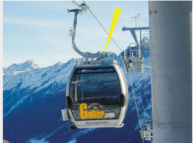
Hydraulische remcilinders verhogen het comfort bij ritten in een kabelbaan
