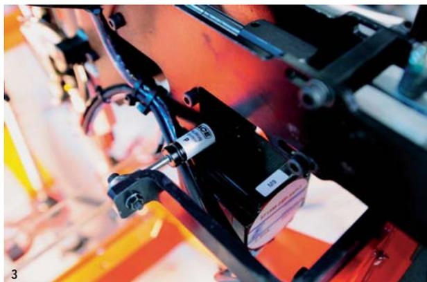
1 ACE bietet hydraulische Bremszylinder mit Durchmessern von 12 bis 70 Millimeter und mit Hüben von 10 bis 800 Millimeter.
